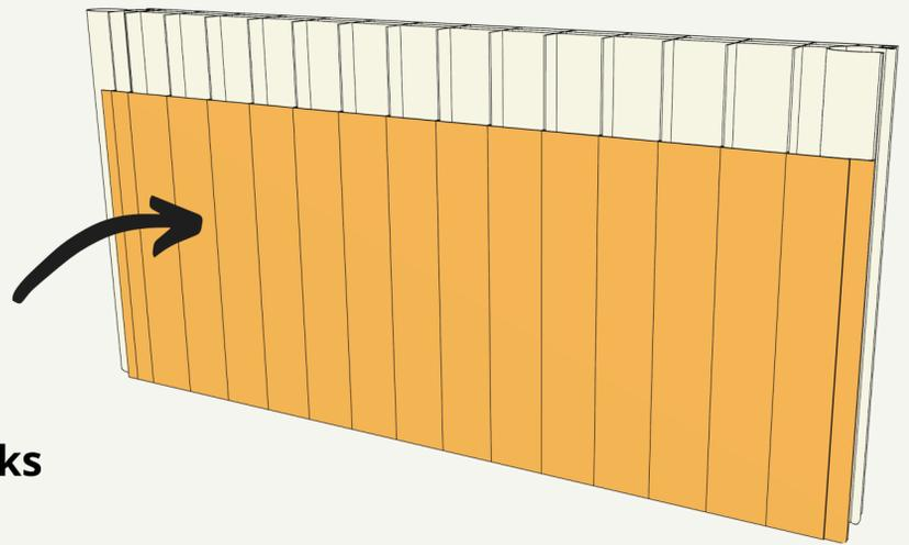
La pared externa de este panel, gracias a la particular tecnología industrial, se produce con material virgen (en transparente u opalino). Las **paredes internas**, en cambio, están protegidas y se producirán con material regenerado y en **colores translúcidos**.
